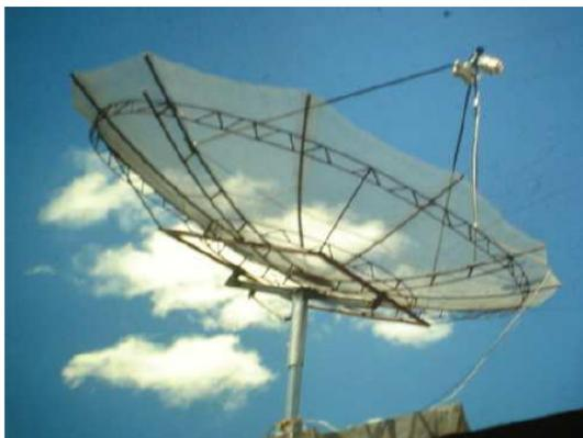
*Figura 2. Reflector parabólico construido en la Facultad de Ingeniería.*
