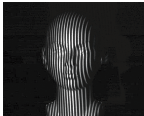
Figura 2. Proyección de franjas sobre un objeto.
