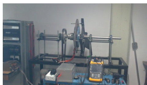
Figura 11. Banco de pruebas para aerogenerador de flujo axial.
