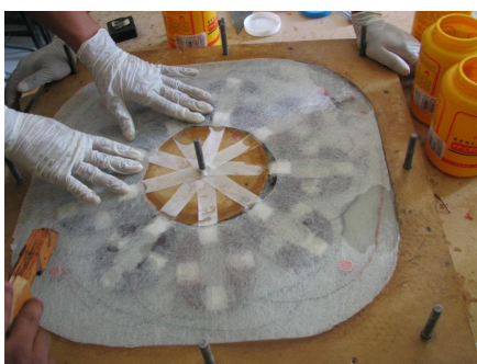
Figura 7. Encapsulado de bobinas con resina.
