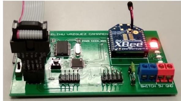
Figura 1. Módulo de adquisición de datos del PMP.
