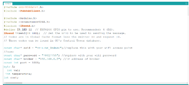
Figura 13: Codificación en IDE de Arduino para conexión a “Broker”
