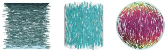
**Figura 3:** Configuraciones que resultan al confinar un CL nemático en (izquierda) canal, (centro) cilindro y (derecha) esfera.
