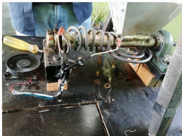
Figura 8: Resistencias utilizadas para el calentamiento de la extrusora plástica
