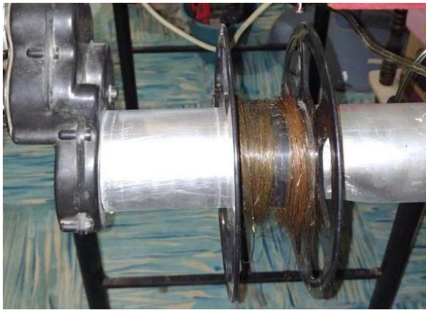
Figura 11: Muestra de extrusión de PLA reciclado previo a la optimización de la extrusora
