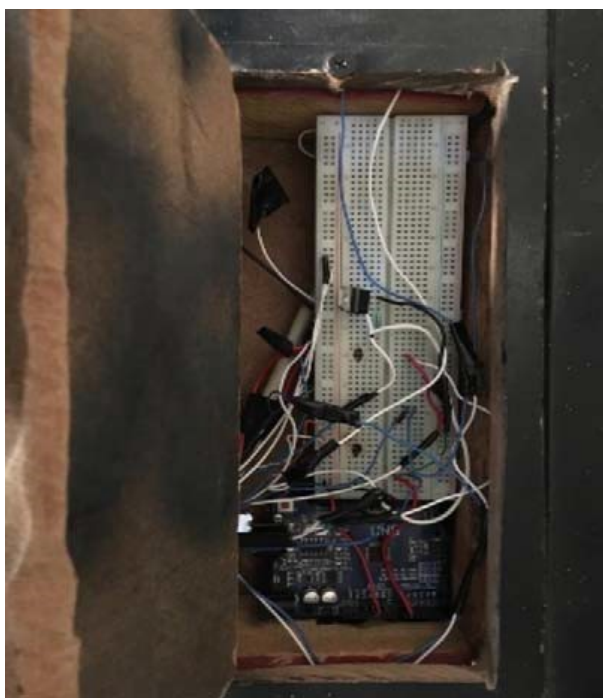
Figura 4: Compartimento de la extrusora para salvaguardar los componentes electrónicos
