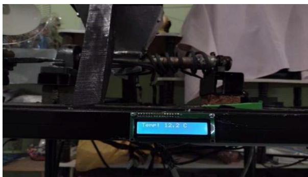
Figura 7: Panel del controlador de temperatura para el proceso de extrusión
