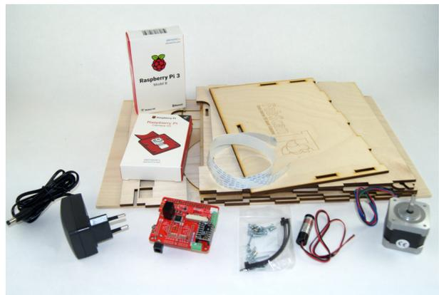
Figura 2: Material necesario para FabScan [3]
