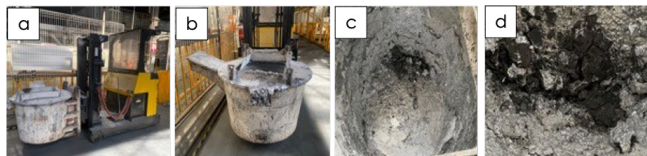
Figura 8: Equipo para traslado de metal fundido, a) montacargas con olla de transferencia, b) olla de transferencia de metal fundido, c) interior de olla y d) suciedad desprendida de paredes refractario
