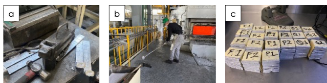
Figura 3: Obtención de muestras para análisis de Molde K: a) Molde K y tabletas de aluminio, b) vaciado de metal en Molde K y c) probetas identificadas obtenidas por la fractura de la tableta
