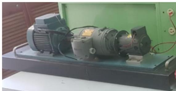
Figura 3: Motor generador
