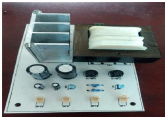
**Figura 3:** Fuente de Voltaje de  $2 \times 12V$
