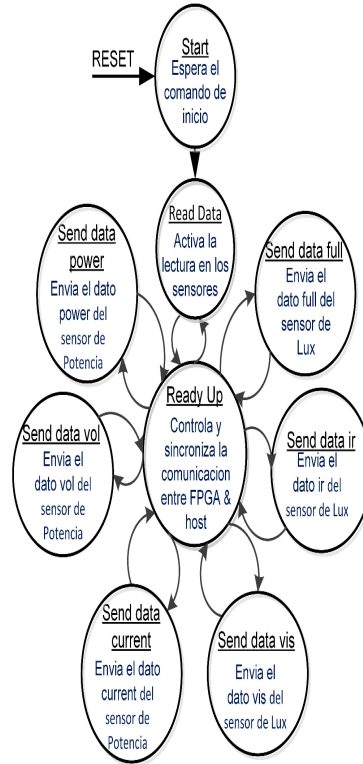
Figura 11: Diagrama de estados simplificado del FSMD del "Control Processor".
