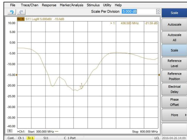
Figura 3.  $S_{11}$  en formato logarítmico (dB) de la antena Cross-Yagi de 300 a 600 MHz.
