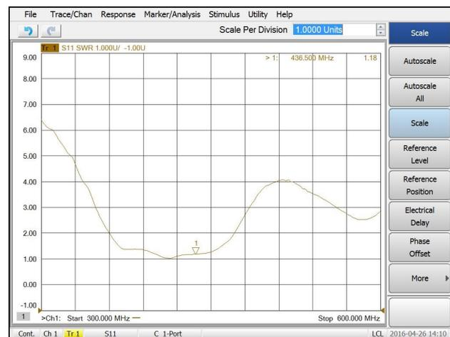
Figura 4.  $S_{11}$  en formato logarítmico (dB) de la antena Cross-Yagi de 300 a 600 MHz.
