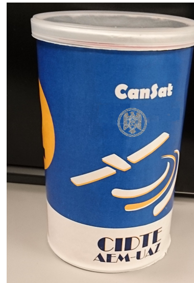
Figura 16. Estructura exterior del Cansat
