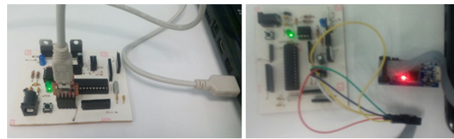
Figura 7. Sistema embebido conectado al programador USBASP y USB serial.
