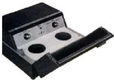
Figura 3. Adaptador acústico para modem (1966).
