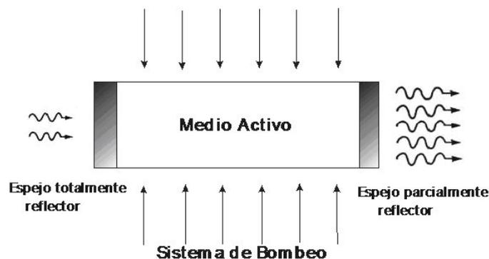
*Figura 1. Partes principales de un láser.*
