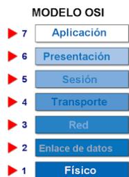
Figura 4. Modelo de REferencia OSI
