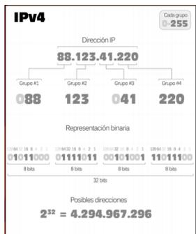
Figura 6. otro ejemplo de direccion ipv4
