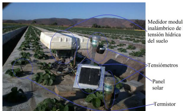
Figura 7. Medidor instalado en un cultivo de fresas.
