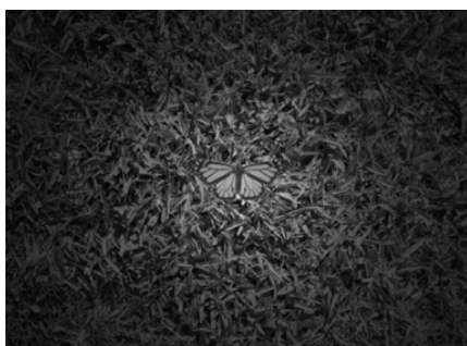
(a) Escena de entrada. Imagen resultante de la degradación por iluminación con niveles \rho = 80, \alpha = 45, \tau = 0 y 40 dB de SNR de ruido aditivo.
