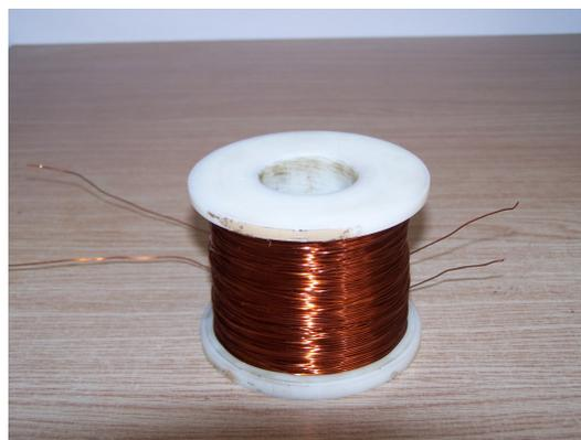
Figura 3. Electroimán diseñado y construido para el levitador magnético.
