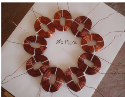
Figura 6. Arreglo de bobinas para el disco del estator.
