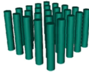
*Figura 2. Una distribución periódica de motivos de diferente constante dieléctrica (en este ejemplo cilindros de semiconductor separados por aire) posee una distribución con bandas de energías y zonas donde no existen estados permitidos (energías prohibidas para fotones).*
