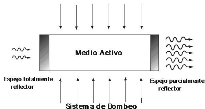
Figura 1. Partes principales de un láser.
