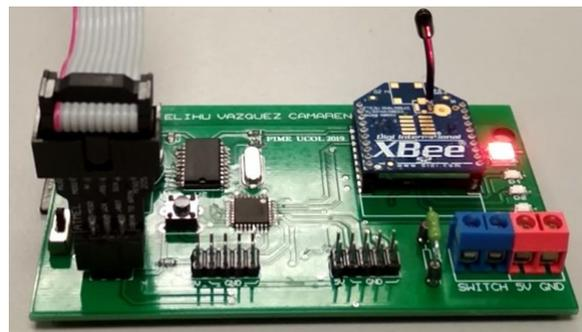
Figura 1. Módulo de adquisición de datos del PMP.
