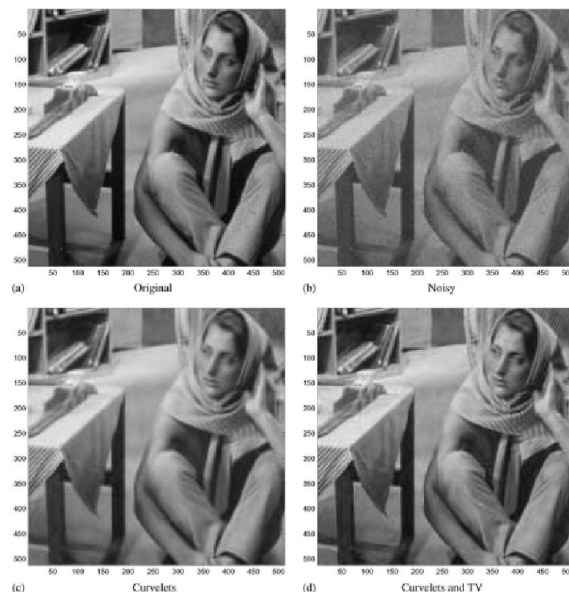
Figura 5. Restauración usando curvelets y variación total (TV) (Figura tomada del trabajo de Candés, y Guo [4]).
