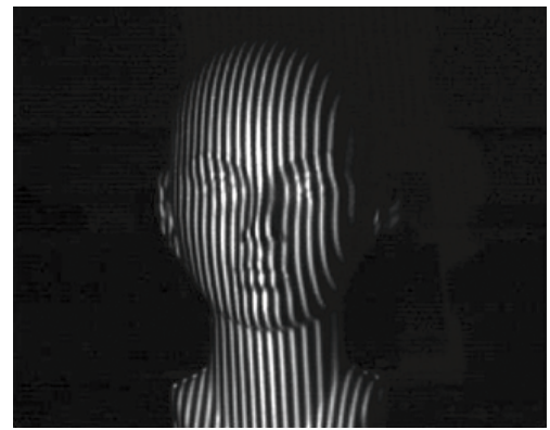
Figura 2. Proyección de franjas sobre un objeto.
