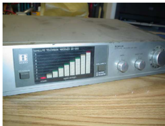
Figura 3. Receptor de satélite empleado en la prueba de la antena parabólica.
