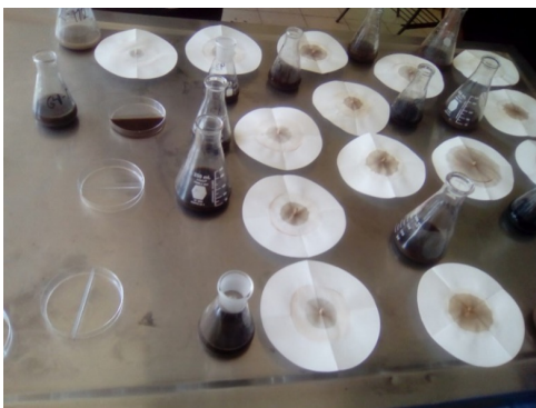
Figura 5: Impregnación de PCC
