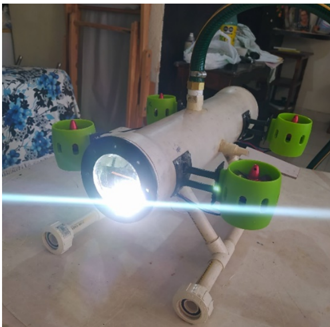
Figura 16: Prueba del led de potencia y el cableado
