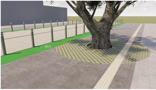
Figura 7: Propuesta de pavimentos permeables 5 metros de diámetro en donde se encuentra el arbolado. Fuente: Elaboración propia (2021)
