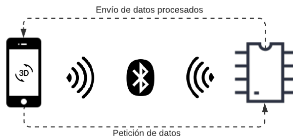
Figura 3: Proceso de inicio de conexión P2P Bluetooth con dispositivo y recepción de los datos
