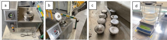
Figura 4: Pruebas RPT: a) Equipo para la RPT, b) crisol metálico en cámara de vacío, c) muestras RPT obtenidas (lado izquierdo, muestras previas a tratamiento y lado derecho son muestras después de tratamiento) y d) balanza instrumentada para obtención de densidad de las muestras
