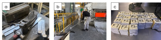
Figura 3: Obtención de muestras para análisis de Molde K: a) Molde K y tabletas de aluminio, b) vaciado de metal en Molde K y c) probetas identificadas obtenidas por la fractura de la tableta
