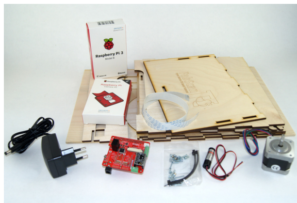
Figura 2: Material necesario para FabScan [3]
