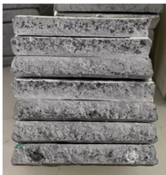
Figura 6: Probeta de Molde K con inclusiones
