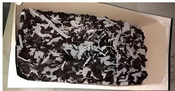
Figura 6: PLA triturado previo a la extrusión para su reciclaje
