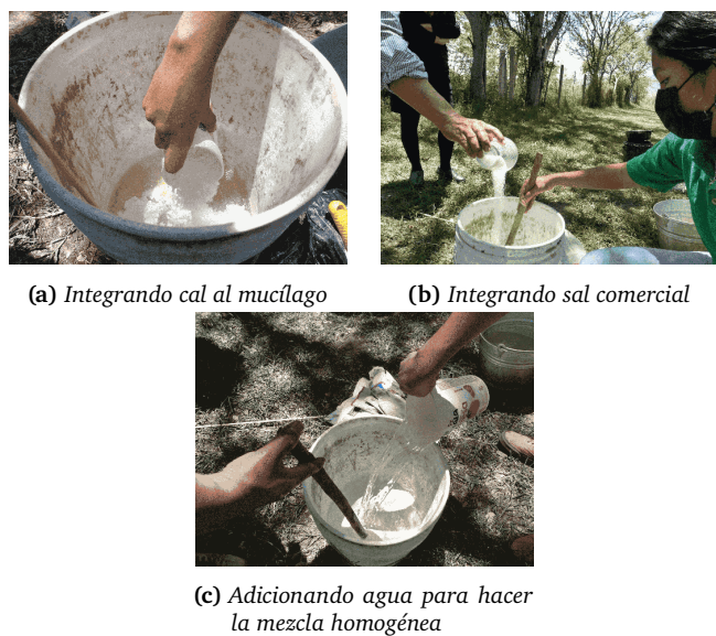
Figura 2: Elaboración de pintura ecológica de nopal y cal
