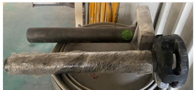
Figura 5: Flechas y rotores para desgasificación ensamblados
