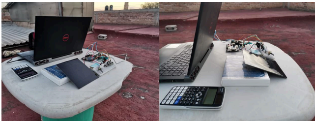
Figura 14: Sistema de sensado y medición de radiación solar basado en la FPGA.
