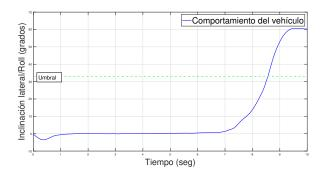
Figura 12: Inclinación lateral (Roll)
