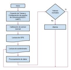
Figura 4: Diagrama de flujo para configuración y detección
