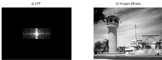
Figura 5. Filtro pasa bajas a) Máscara utilizada b) Imagen filtrada
