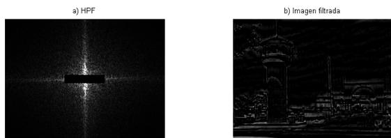
Figura 6. Filtro pasa altas a) Máscara utilizada b) Imagen filtrada
