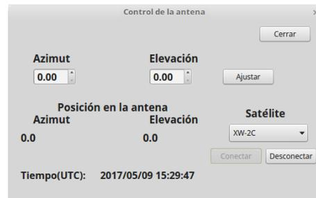
Figura 5. Interfaz para el control de los rotores de una Estación Terrena.
